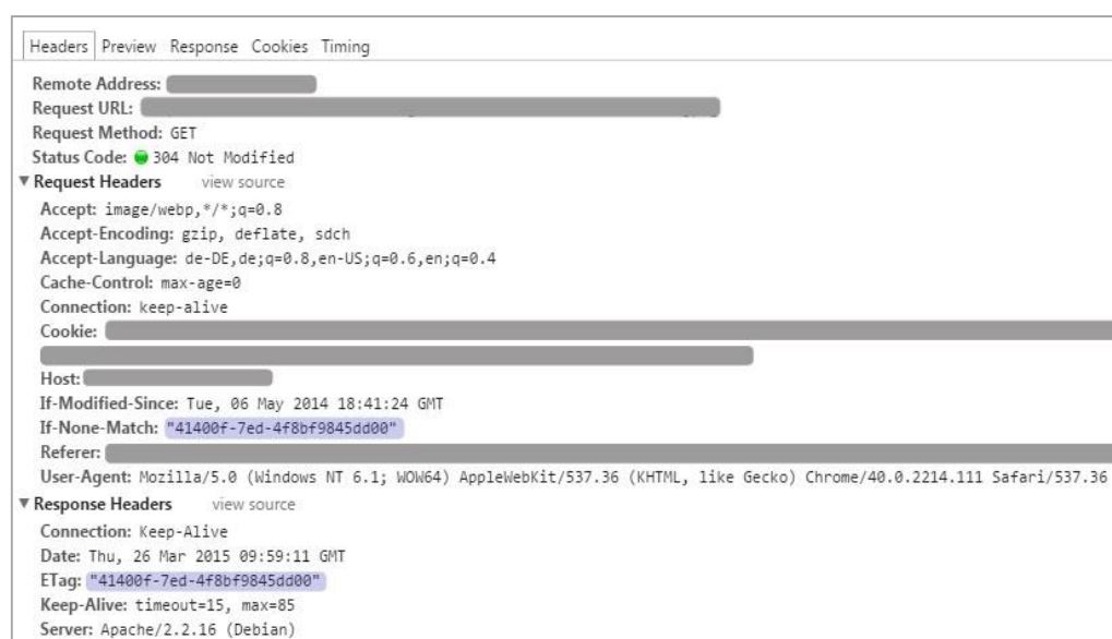
Abb.: Server-Request-Header und dessen Response-Header inklusive eTag
